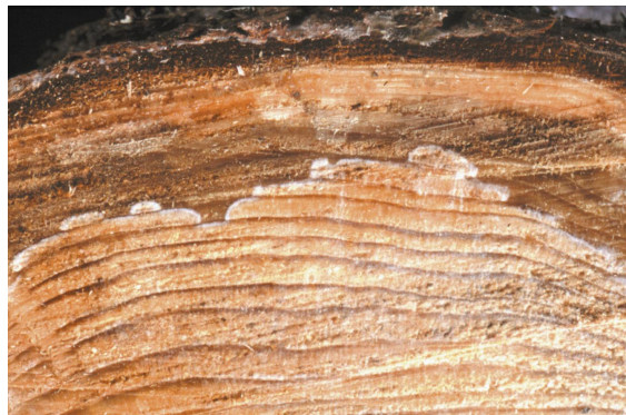
Opis: Kolobar smrekovega debla s trosonosci in trosi (konidiji) trohnobneža, ki jih vidimo s prostim očesom kot belo prevleko na meji med okuženim in neokuženim lesom Avtor slike: Jurc Dušan
