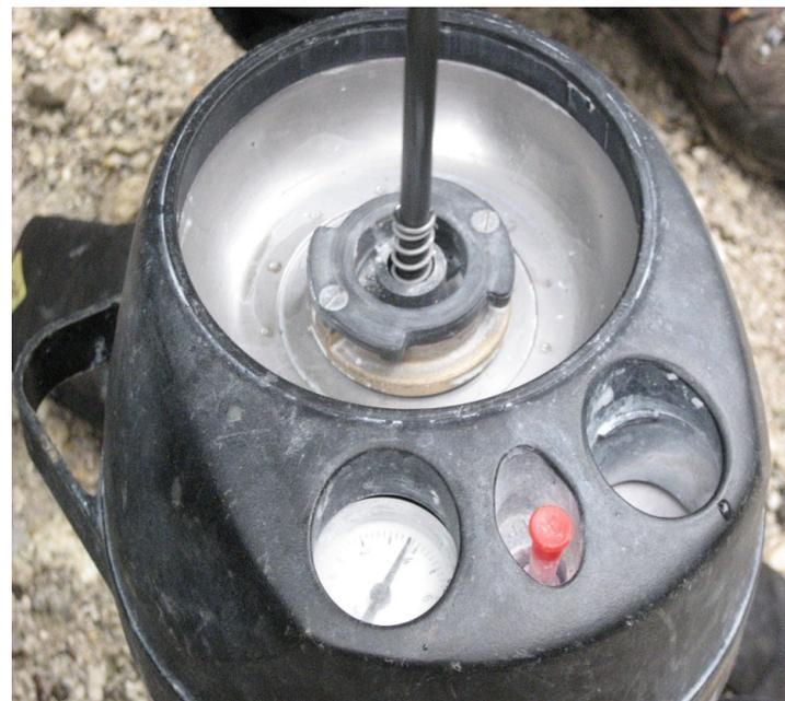
**Visokotlačno škropilnico pripravimo na delovni tlak 5 do 7 barov**
