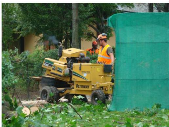
Slika 15: Dnišče debla in korenine stroj zmelje v lesne sekance (Foto: Erika Orešek)
