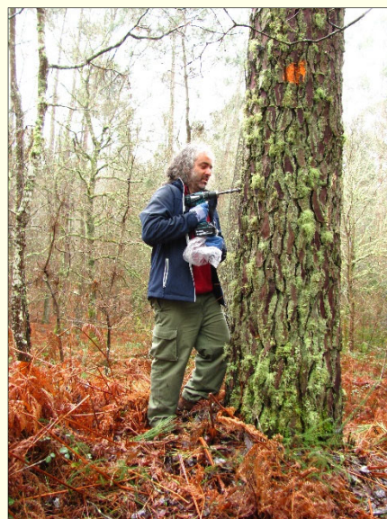
Slika 7: Prikaz odvzema vzorcev za testiranje na prisotnost borove ogorčice, Bursaphelenchus xylophilus (foto: A. Kavčič)
