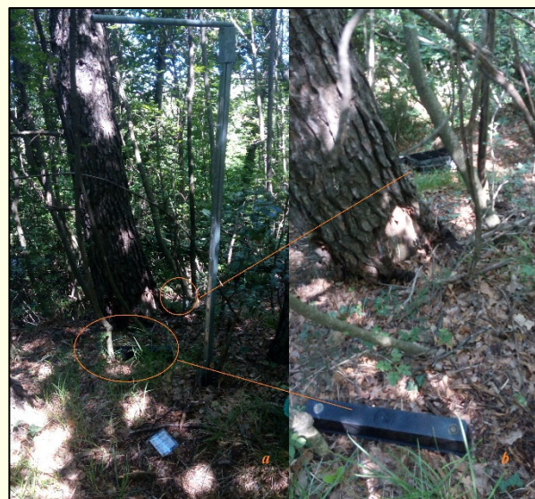
Slika 3: Razdrta (uničena) režasta past tipa Theysohn, namenjena za spremljanje vektorjev glive Fusarium circinatum , ki povzroča borov smolasti rak, je posledica vandalizma (a, b) (foto: P. Smolnikar, GIS)
