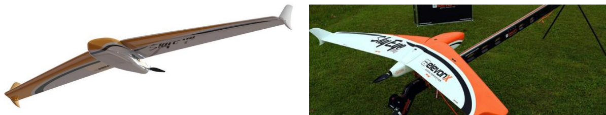
Slika 3: Brezpilotni krilati letalnik ElevonX SkyEye Delta in pripadajoči katapult za izstrelitev (foto ElevonX).
