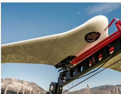
Slika 2: Brezpilotni krilati letalnik C-astral Bramor ppX in pripadajoči katapult za izstrelitev (foto C-astral).
