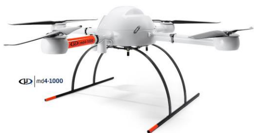
Slika 1: kvadrokopter MD4-1000 proizvajalca Microdrones GmbH (foto Microdrones).
